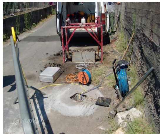
Fig. 9 – Schematizzazione di una prova down-hole. Fig. 10 – Esecuzione di una prova down-hole.
